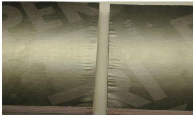
После полного насыщения волнистость с поверхности листов почти полностью исчезает, как правило, это происходит уже через 2-3 цикла контактов фанеры с водой с просушиванием между каждым контактом.
